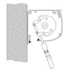
Sortie verticale sous coffre
