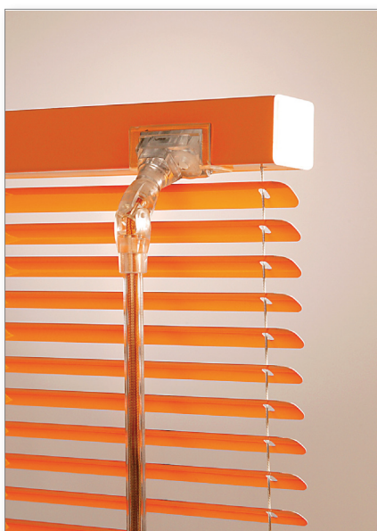
Manœuvre Top Control, les cordons de levage traversent la tige d'orientation, le frein s'actionne en tirant sur la tige d'orientation
